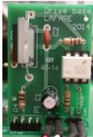
Figura 45: Driver de base do MOSFET.
